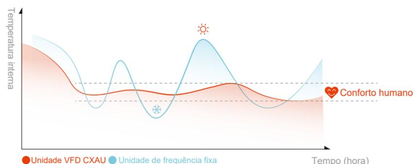
A tecnologia VFD permite uma maior precisão no controle da temperatura interna, o que resulta em poucas flutuações de temperatura e uma sensação maior de conforto nas pessoas.
