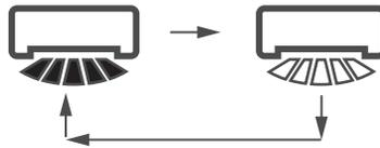
Figura 37: Sequência de ajuste do difusor horizontal
