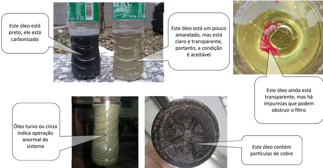
**Figura 91: Inspeção do óleo do compressor**
