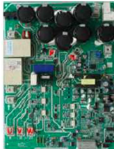
Figura 88: Terminais do módulo inverter (220 V)
