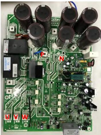
Figura 74: Terminais do módulo inverter (220 V)
