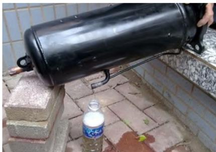
**Figura 89:** Drenagem do óleo de um compressor
