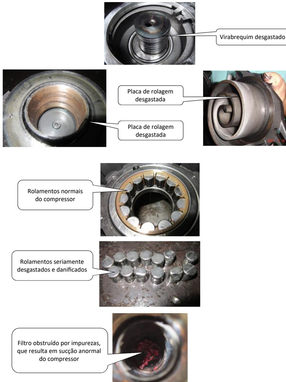
Figura 92: Efeitos do óleo deteriorado do compressor
