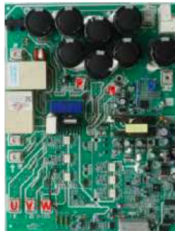
Figura 75: Terminais do módulo inverter (380 V)
