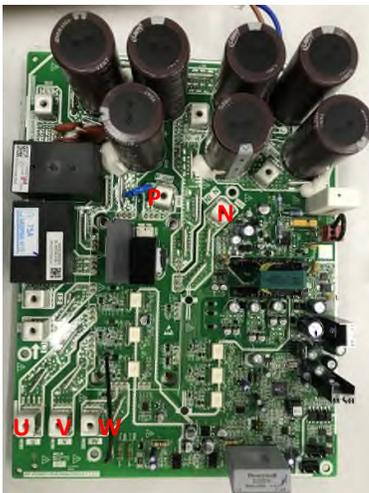
Figura 87: Terminais do módulo inverter (220 V)
