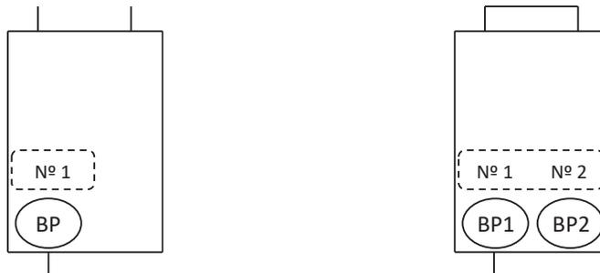
Figura 38: Prioridade e rodízio do compressor – uma unidade externa
