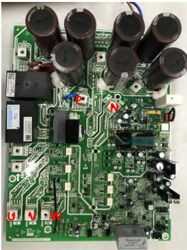
Figura 85: Terminais do módulo inverter (220 V)
