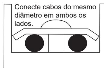
**D** Não conecte os cabos da fonte de alimentação de mesmo diâmetro no mesmo lado do terminal. Não use dois cabos de alimentação de diferentes diâmetros no mesmo bloco terminal, pois estes podem se soltar facilmente devido à pressão irregular e causar acidentes, conforme ilustrado na figura abaixo.
